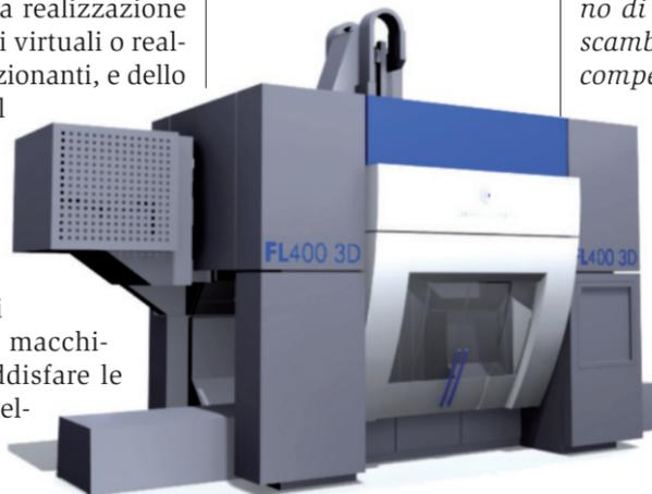
La carrozzeria della macchina per taglio laser FL400 3D è stata progettata da Fishform, secondo le specifiche funzionali e di utilizzo, ottimizzando i ripari dove necessario, poi nobilitati da una sorta di "vela sospesa" che caratterizza ed identifica l'area lavoro della macchina.
